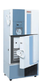
기계식냉동고 저장용량 48,600 vials 보관자원 DNA, 요, 전혈 등 냉각방식 전원압축기 저장온도 -73°C ~ -77°C 챔버용량 792.8ℓ
