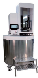
자동화(semi-auto) 액체질소냉동고 저장용량 21,600 vials(216 box) 보관자원 혈청 냉각방식 액체질소 저장온도 -150°C ~ -196°C 챔버용량 667ℓ
