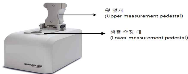
그림 V-3-1. NanoDrop의 구조(ND2000, Thermo Scientific Inc.)
