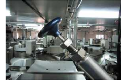
그림 8-20. 진공밸브 닫힘 상태
