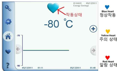
그림 9-70. 컨트롤러 작동상태(TSU모델)
