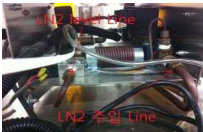
그림 8-60. 주입과 Level line 위치(정면)
