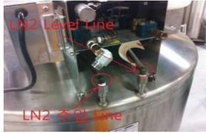
그림 8-59. 주입과 level line 위치
