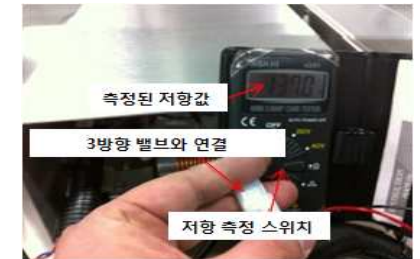
그림 8-14. 3방향 밸브 저항 값 측정
