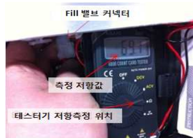
그림 8-10. 주입 솔레노이드 밸브(2개 측정)
