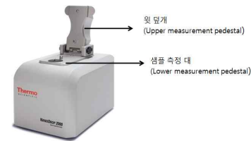
그림 III-2-4. ND-2000의 구조 그림 III-2-5. NanoDrop의 측정대(Measurement pedestal)
