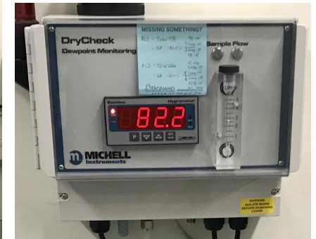
그림11-61. 필터드라이어의 듀포인트 모니터
