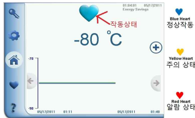
그림 9-53. 컨트롤러 작동상태(TSU모델)
