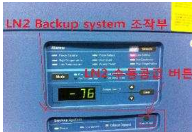
그림 9-94. 액체질소 백업시스템 조작부 그림 9-95. 컨트롤러 버튼과 표시등 위치
