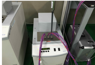
그림 10-46. Calibration bath에 센서 설치
