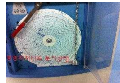
그림 9-45. 중앙지지너트 분리 상태
