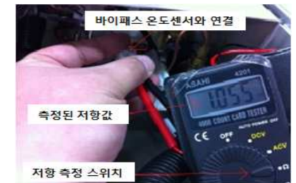
그림 8-16. 바이패스 온도센서 측정
