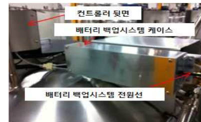
그림 8-68. 배터리 백업시스템 장착위치
