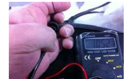
그림 8-18. 온도센서 저항 값 측정
