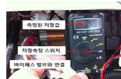
그림 8-13. 바이패스 밸브 저항 값 측정
