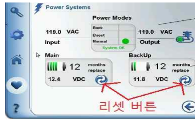
그림 9-71. 배터리 교체 리셋 버튼
