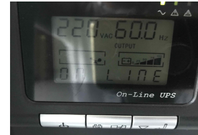
그림 11-44. UPS 상태 표시
