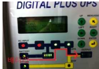
그림 5-14. 정전상태 표시
