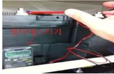
그림 5-4. 배터리 전압 측정
