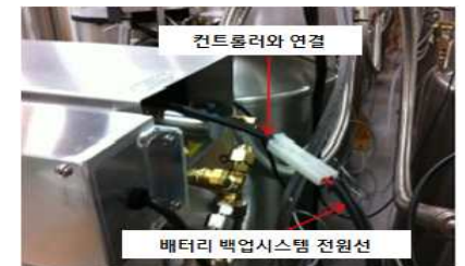
그림 8-69. 배터리 백업시스템 전원선
