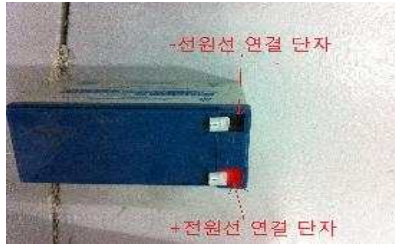
그림 9-69. 배터리 전압측정 단자 위치
