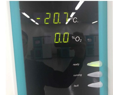
그림 11-2. 챔버 온도, 산소농도와 상태표시등
