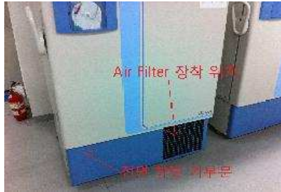
그림 9-55. 에어필터 장착 위치
